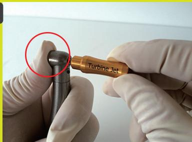
バックキャップを強く押しノズルを垂直に差し込む。
